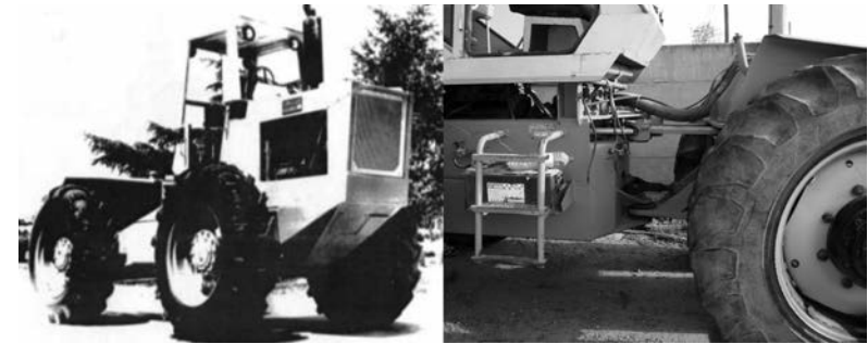
Ilustración 1. Tractor agrícola Zanello y sistema de articulación de chasis
